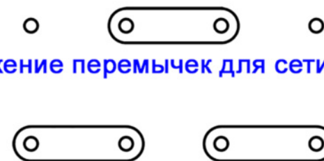
Положение перемычек для сети ~127 В
